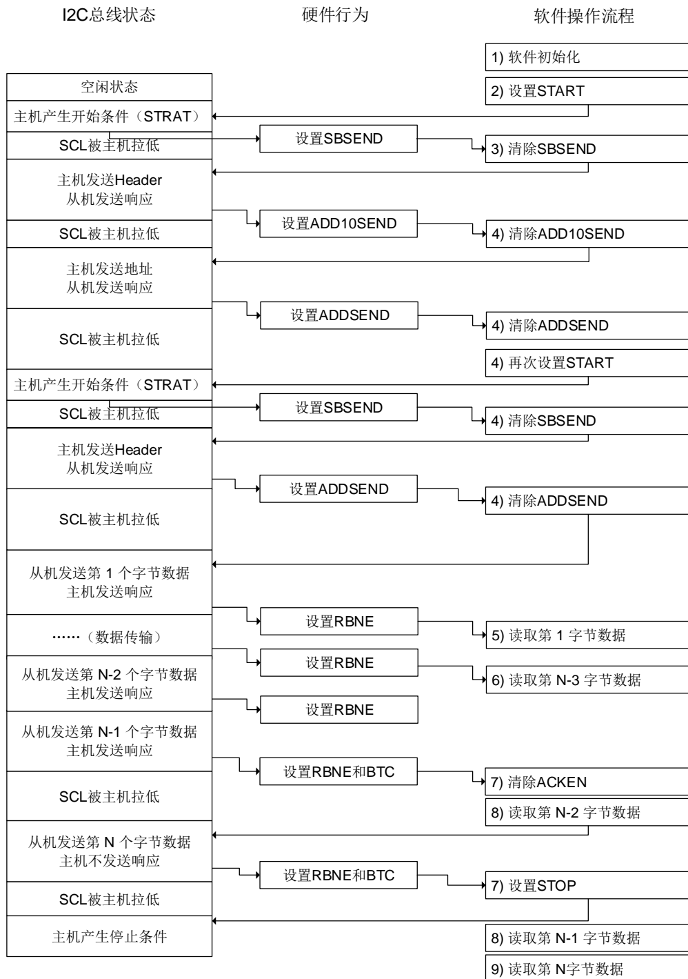
图 21-13. 主机接收使用方案 B 模式（10 位地址模式）
