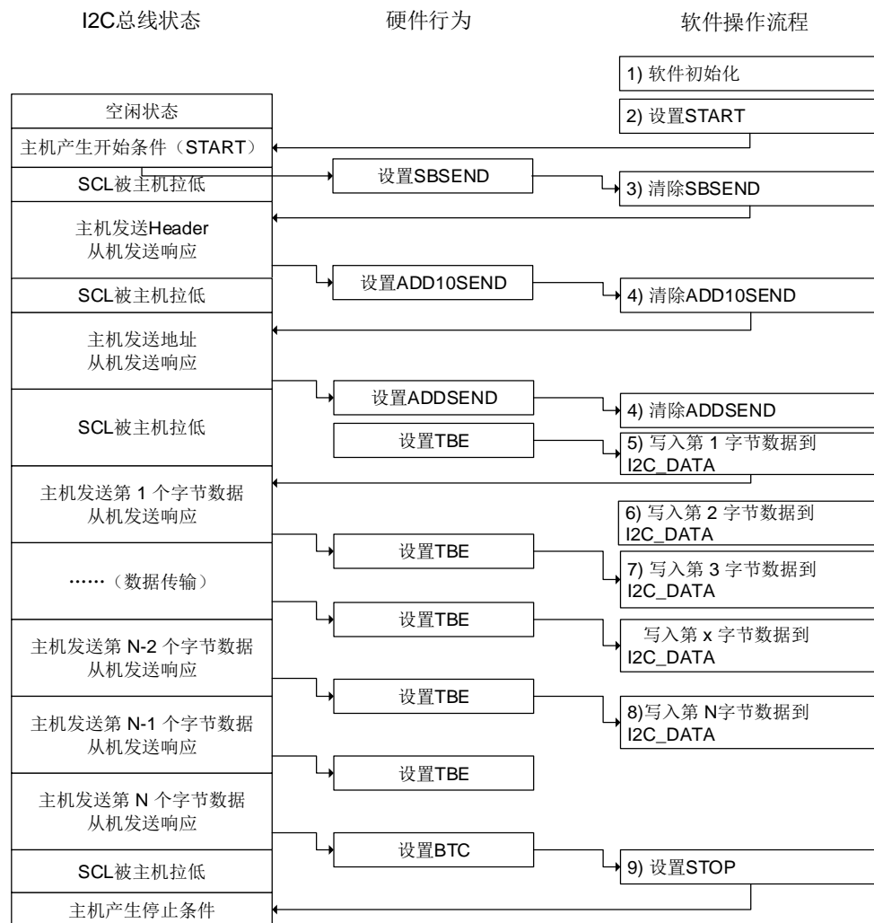
图 21-11. 主机发送模式 (10 位地址模式)
