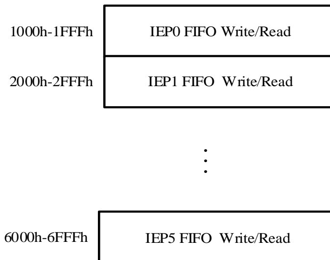
图 29-9. 设备模式 FIFO 访问寄存器映射表
