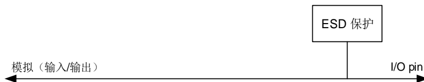
图 8-4. 模拟配置的基本结构
