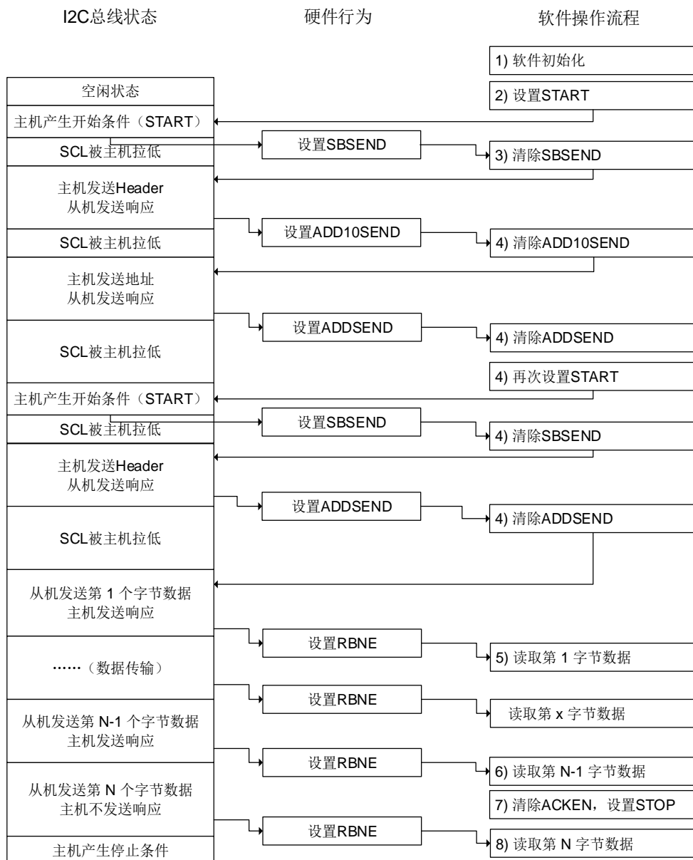
图 21-12. 主机接收使用方案 A 模式（10 位地址模式）
