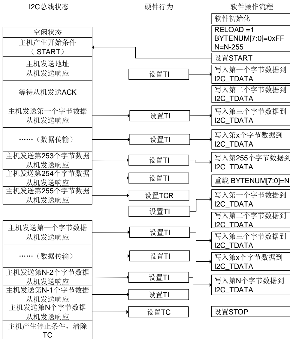
图 21-32. I2C 主机发送编程模型 (N&gt;255)
