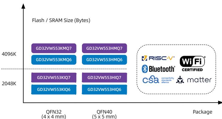
兆易创新为全新GD32VW553系列微控制器提供了免费开发环境GD32 IDE、调试下载工具GD-LINK与多合一编程工具GD32 All-In-One Programmer。还同步推出了包含底层驱动、无线协议栈、应用例程等功能的SDK。并适配多种支持本地、云连接、安全和无线升级(OTA)功能的实时操作系统(RTOS)，方便联网终端的快速部署。符合由国际组织连接标准联盟(CSA)开发的Matter over Wi-Fi应用标准，支持采用GD32VW553的各种Matter设备无缝互连，提高智能家居系统的兼容性和互操作性。GD32VW553系列MCU还通过了Wi-Fi联盟(WFA)的Wi-Fi 6认证、蓝牙技术联盟(Bluetooth SIG)的Bluetooth认证以及RF FCC/CE合规认证。
