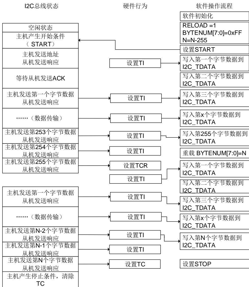
图 20-19. I2C 主机发送编程模型 (N>255)
