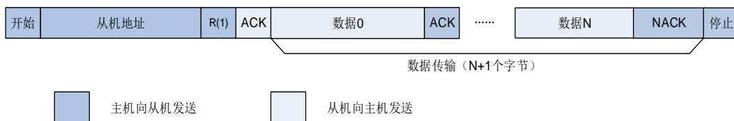
图 20-6. 7 位地址的 I2C 通讯流程（主机接收）
